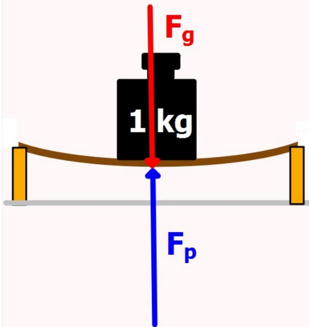
Dvě síly působí na těleso v jedné přímce, mají stejnou velikost, navzájem opačný směr.
